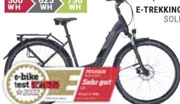
Bosch Performance Line Antrieb mit 75 Nm,
