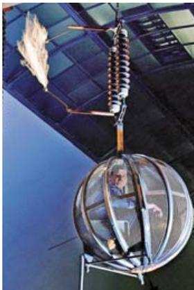
In der Starkstrom-Abteilung: Bei täglichen Vorführungen erleben die Besucher Experimente mit Wechselspannung bis 300.000 Volt (Lichtbogen u.a.) und mit impulsartigen Spannungen, die Blitzeinschläge simulieren und ihren Höchstwert von 800.000 Volt in zwei millionstel Sekunden erreichen. Die Starkstromvorführung findet seit 1953 statt. Hier ist der Faradaysche Käfig zu sehen.
