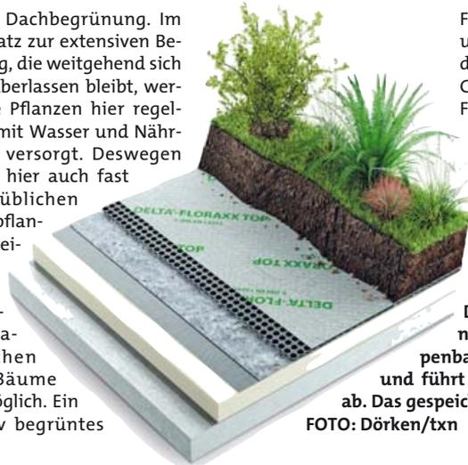
Damit die Pflanzen im Dachgarten gut gedeihen, muss Staunässe vermieden werden. Hierfür sorgt eine spezielle Noppenbahn unter dem Pflanzsubstrat. Sie speichert Regenwasser und führt gleichzeitig überschüssige Niederschläge dauerhaft sicher ab. Das gespeicherte Wasser hilft den Pflanzen über Trockenzeiten hinweg.
