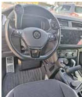
Wir bieten verschiedene Handsteuerungen an. Hier Gas und Bremsen durch Drehen und Drücken.
