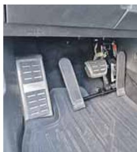
Hier wurde das Gaspedal auf Links verlegt, wodurch Gas und Bremse mit dem linken Fuß bedient werden.
