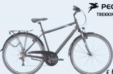
Shimano 21-Kettenschaltung, Suntour Federgabel, Tektro V-Brakes, MonkeyLoad Systemgepäckträger, moderne Lichtanlage, leichter Alu-Rahmen
